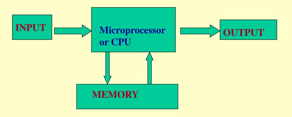
FIG - BLOCK DIAGRAM OF DIGITAL COMPUTER
